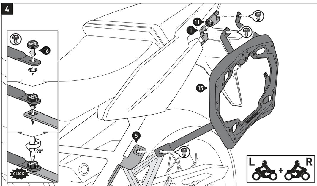
Verbinden Sie die Kofferträger (15) mit den Schnellverschlüssen (16) an den Befestigungslaschen (5)/(8) und (11) und dem Querverbinder (1). Sichern Sie die Schnellverschlüsse mit den Sicherungsscheiben.
