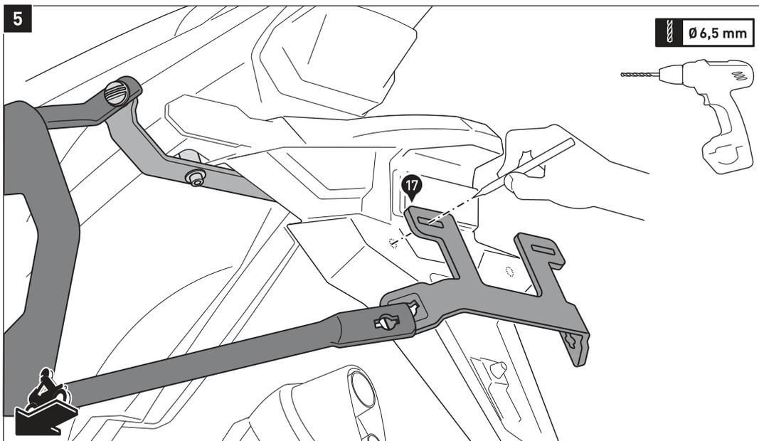
Markieren Sie mit einem geeigneten Stift die Befestigungsbohrungen des Querverbinders (17) auf dem Kotflügel. Lösen Sie anschließend die Schnellverschlüsse (16) und entfernen Sie den Querverbinder (17) und die Kofferträger (15) vom Fahrzeug.
