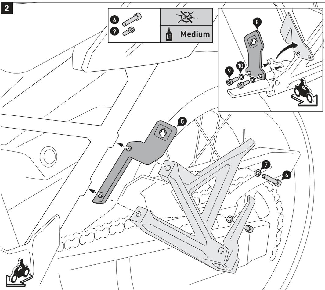
Montieren Sie die Befestigungs-
