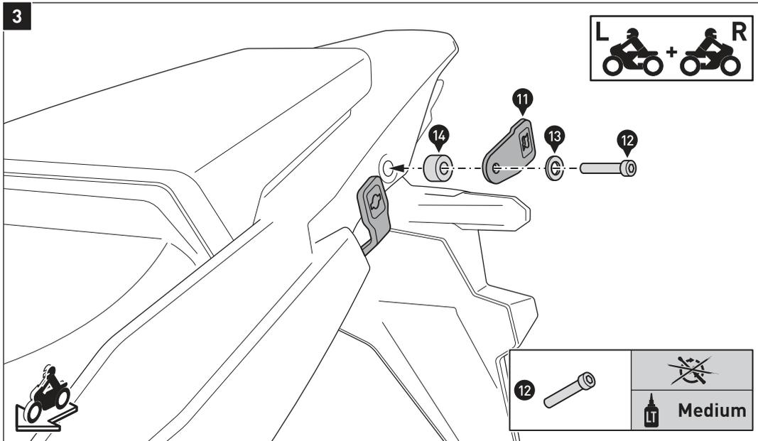
Entfernen Sie Schrauben auf beiden Seiten des Fahrzeugs von den Anbaupunkten.
