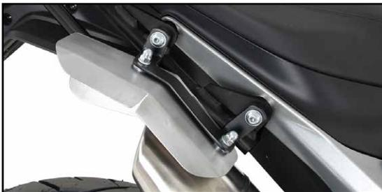
Bei langen Autobahnfahrten entsteht durch die Auspuffsituation ein enormer Hitzezustau, der zum Schmelzen vom Topcasekunststoff oder anderen Gepäckstücken führen kann. Wir empfehlen daher unbedingt die Verwendung unseres optionalen Hitzeschutzblechs Art.Nr.: 42247569 00 91/42247602 00 91
